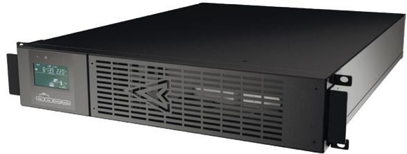
ИБП ИМПУЛЬС серии ФОРВАРД, мощностью от 6000 ВА до 10000 ВА, представляют собой однофазные устройства, построенные по технологии онлайн (двойное преобразование энергии с независимым уровнем напряжения и частоты на выходе), что позволяет получить качественное синусоидальное напряжение для питания электронного оборудования, чувствительного к искажениям и помехам.
